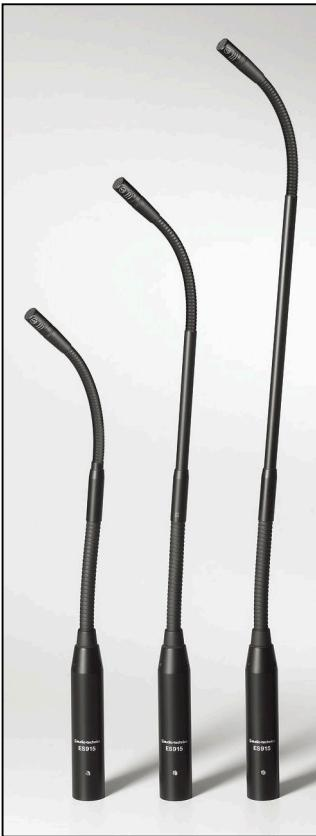
ES915C 是一枚阔频宽的电容式心形指向性话筒，高质量的收音效能，设计于增强收音、专业录音、电视广播、会议等高要求的收音应用。双鹅颈的设计，可将收音头灵活调校到任何位置，并附有防风海棉罩，可减低在讲话时收到不雅的喷气声及其他风声的情况出现。
